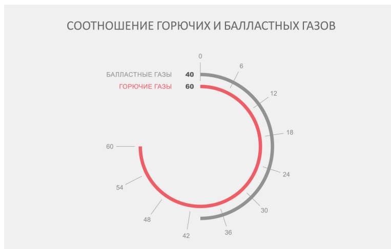
Рис.2. Соотношение горючих и балластных газов биогазового комплекса.
